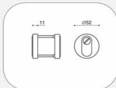
bocchetta di sicurezza d. 52 mm con cilindro regolabile per sporgenze da 10 a 15 mm con sottobocchetta in acciaio temprato antitrapano
