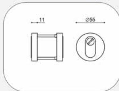
bocchetta di sicurezza d. 55 mm con cilindro regolabile per sporgenze da 10 a 15 mm con sottobocchetta in acciaio temprato antitrapano
