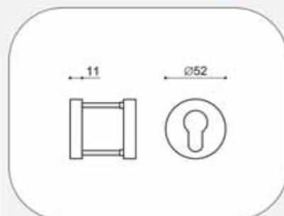
bocchetta di sicurezza d. 52 mm con foro yale con sottobocchetta in acciaio temprato antitrapano
