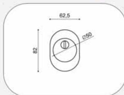
Bocchetta di sicurezza d. 50 mm con sottobocchetta in acciaio temprato antitrapano
