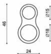
Anello di protezione da applicare sull'impugnatura della maniglia per evitare collisioni e urti nella fase di apertura della porta
